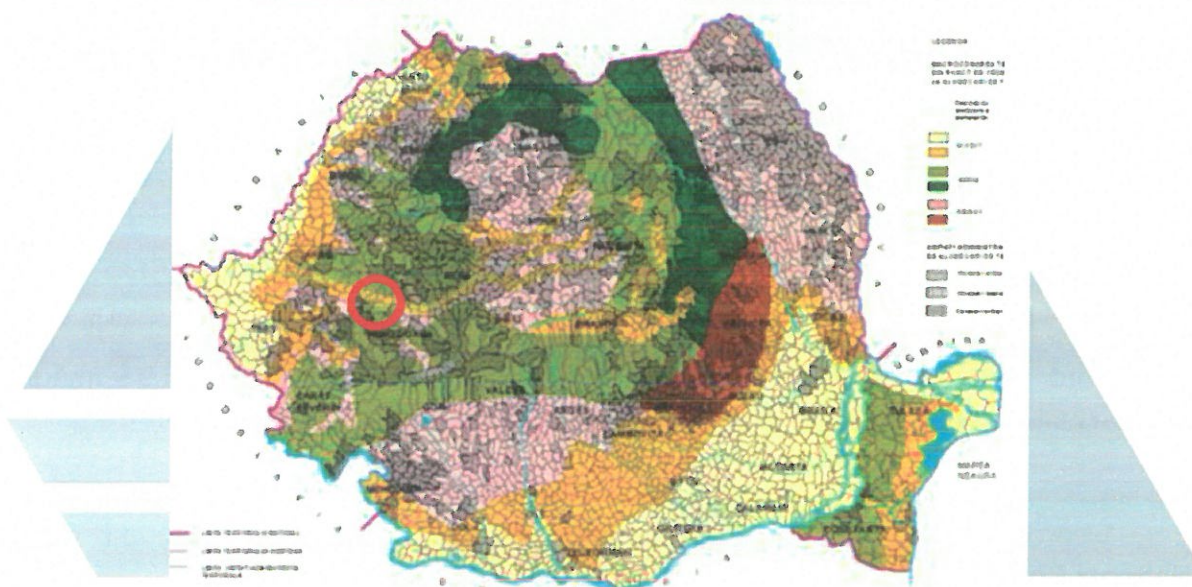
Foto 11 — Planul de amenajare a teritoriului național secțiunea a V-a — Zone de risc natural: Alunecări de teren - în conformitate cu anexa nr. 6a, tipul de alunecări ce pot apărea în zonă sunt cele reactive.
