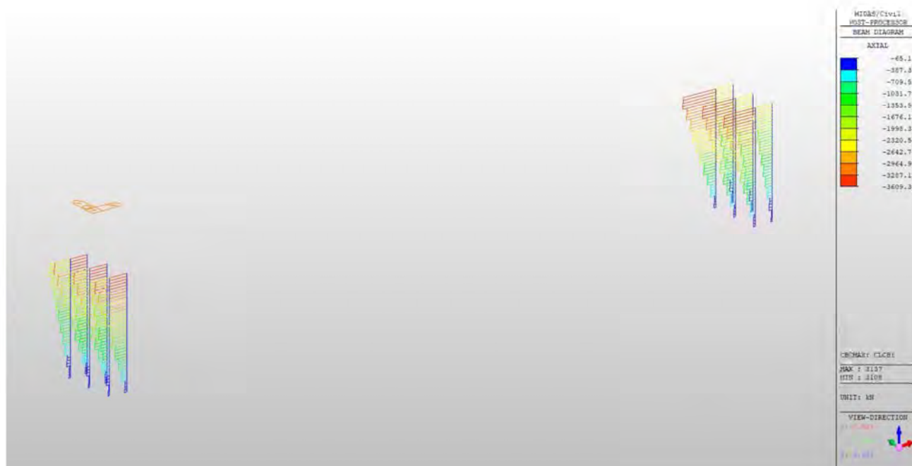
Fig. 6 Solicitări axiale maxime la piloți din culee
