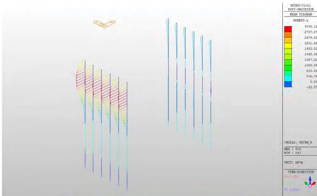
Fig. 7 Diagrama de moment încovoietor maxim din gruparea cLCB1
