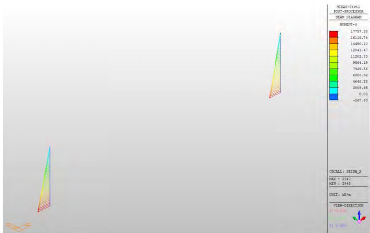
Fig. 13 Moment încovoietor maxim în stâlpul pilei
